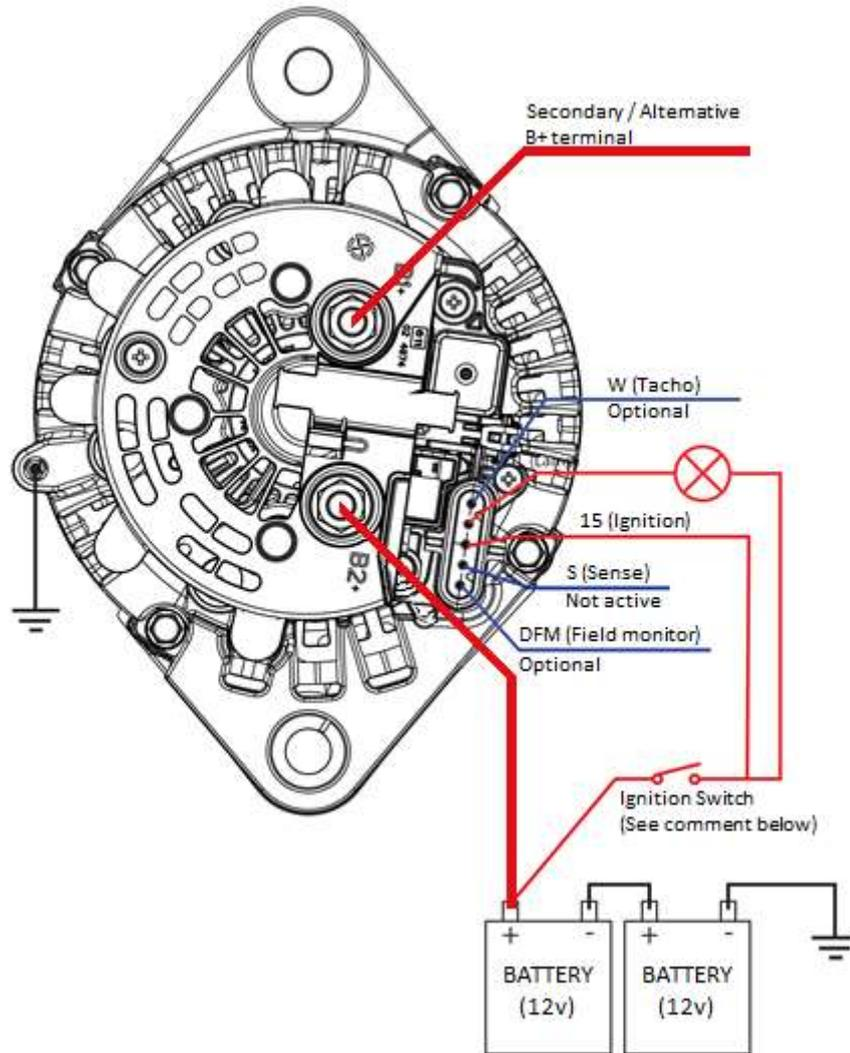
Figure 30: 24v 120A Alternator Wiring
